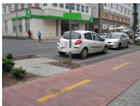
Rys. 5.16. Korytarz dostępu, jako boczna odnoga chodnika głównego nie wymusza obniżenia chodnika głównego i podwyższenia jezdni
