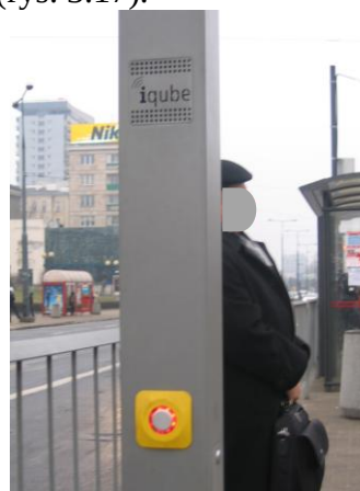
Rys. 3.17. Przycisk uruchamiający informację głosową
