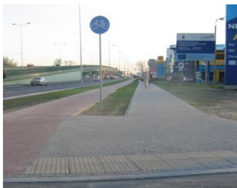
Rys. 1.2. Poprawny przekrój: jezdnia dla pojazdów - droga dla rowerów – chodnik
