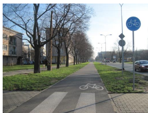
Rys. 1.2. Poprawny przekrój: jezdnia dla pojazdów - droga dla rowerów – chodnik
