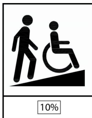
Rys. 1.18. Oznakowanie znakiem ISO z tabliczką oznaczającą wartość pochylenia
