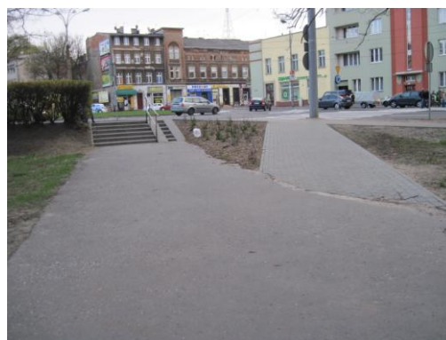
Rys.1.11. Pochylnia, jako alternatywne rozwiązanie – oddzielone do schodów
