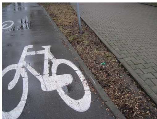
Rys. 1.1. Należy unikać łączenia drogi dla rowerów z chodnikiem
