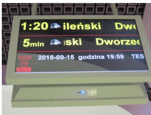
Rys. 3.18. Tablica wyświetlająca informacje, w tym front pociągu symbolizujący typ pojazdu
