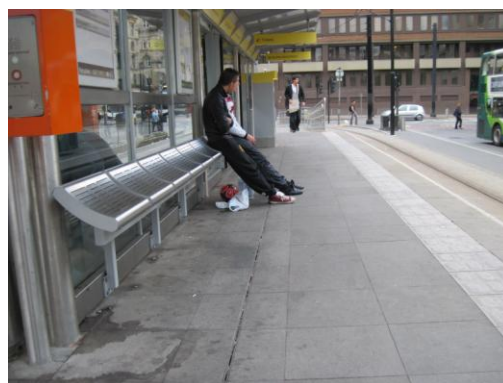
Rys. 3.21. Parapety ułatwiające stanie w tzw. siadzie stojącym
