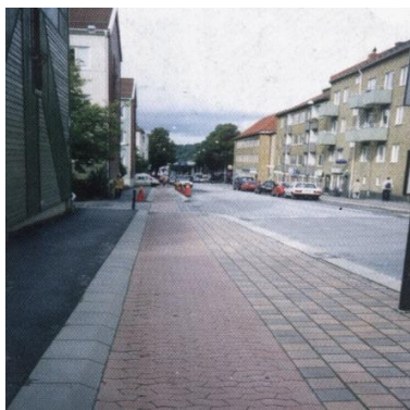
Rys. 1.3. Chodnik powinien tworzyć spójny ciąg odcinków z łagodną zmianą kierunku i szerokości
