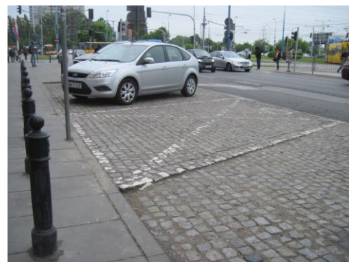
Rys. 5.11. Koperty z obniżonym chodnikiem lub podniesioną nawierzchnią
