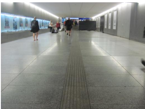
Rys. 2.23. Pas prowadzący w przejściu o szerokości większej niż 4,0 m
