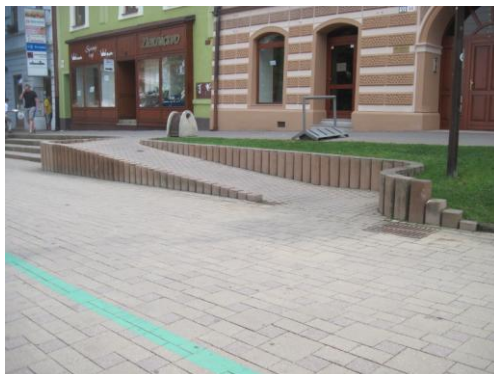
Rys. 1.12. Przykład jednoczesnego zastosowania schodów i pochylni
