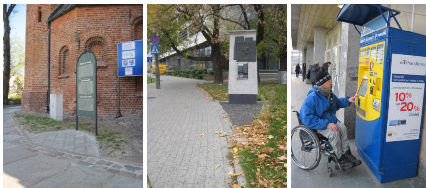
Rys. 6.4. Przykłady usytuowania tablic informacyjnych poza szerokością użytkową chodnika oraz wysokości usytuowania ekranów i przycisków
