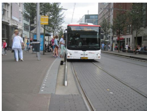
Rys. 3.8. Rury zabezpieczają przed uderzeniami kół o krawężniki i przecinaniem opon
