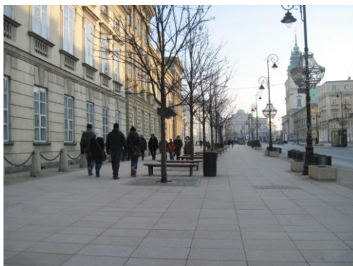
Rys.1.24. Podstrefa śródchodnikowa usytuowana na środku chodnika zapewnia swobodne przejście po obu jej stronach
