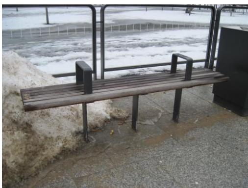
Rys. 3.20. Ławka o dwóch podłokietnikach ułatwiających wstawanie
