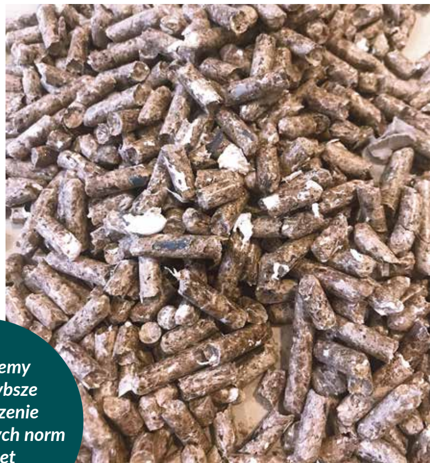
fot. Pellet zanieczyszczony plastikiem, zdjęcie pelletu nadanego do Krakowskiego Alarmu Smogowego
